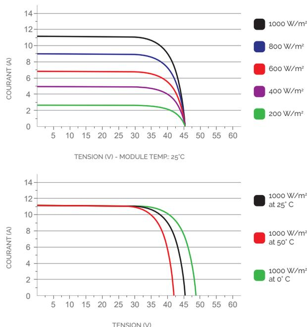
1. STC: (Standard Test Condition): Rayonnement 1000W/m<sup>2</sup>, Temp. Module 25°C, Masse de d'air 1.5
